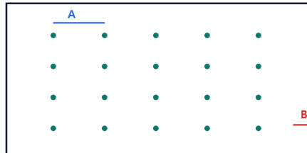
18번 슈미트해머 타격 위치 (자격증3001 자체 제작도)
